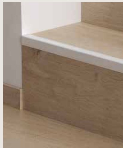
PROFIL WYKOŃCZENIOWY DO SCHODÓW, SREBRNY 2500 × 30 × 25 mm Pasuje do podłóg o grubości 7-15 mm. Aluminium. PGSTPSILVME250
