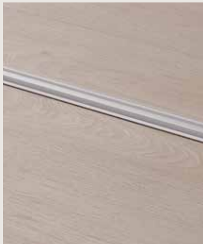
PROFIL WIELOFUNKCYJNY, SREBRNY 1860 × 47 × 16 mm Profil dylatacyjny i wyrównujący w jednym. Odpowiedni do różnic wysokości wynoszących od 0 do 12,3 mm. Wysokość: 10 mm (przed montażem) Aluminium. PGPRSILV
